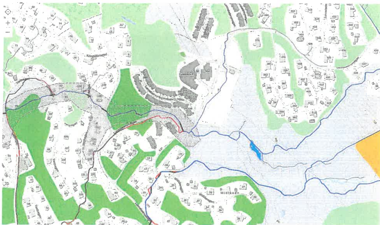
Kart som viser dreneringslinjer (blå) og tette stikkrenner (røde). Flomfare er markert med skravur. (Kilde: Innlands-GIS)
